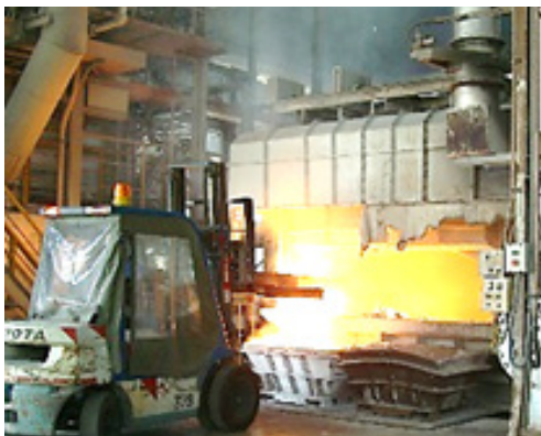
Antes: método manual de fundición de chatarra
