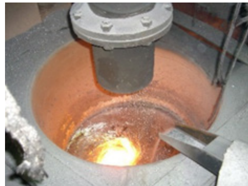
Después: el sistema Pyrotek LOTUSS funde la chatarra de manera continua
